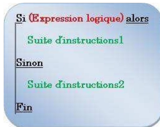
Structure générale de l'instruction conditionnelle
